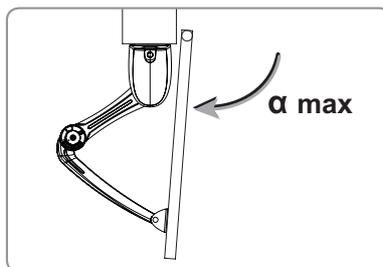
[2]. Installer la butée côté vantail, en butée contre l'épaulement du bras moteur.
