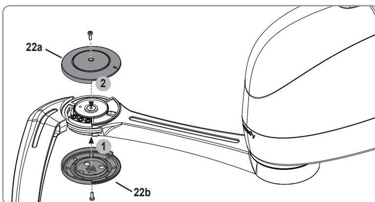
[7]. Fixer définitivement la chape vantail en utilisant le trou de fixation central.
