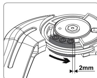
[5]. Serrer définitivement la butée avec une clé allen longue pour plus de couple au serrage des vis de la butée (16 Nm).
