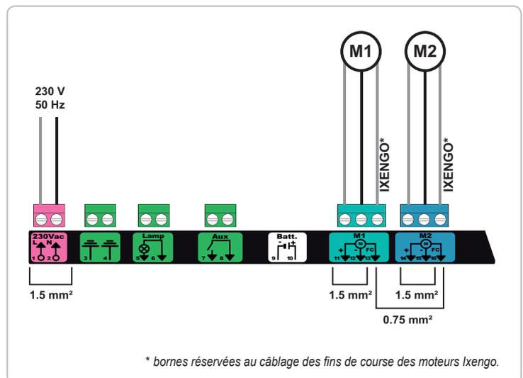
\* bornes réservées au câblage des fins de course des moteurs Ixengo.
